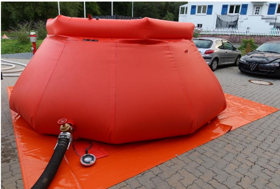
Abb. 7.2: Faltbehälter zur Löschwasserspeicherung, 15.000 Liter [FF Eppstein-Vockenhausen]
