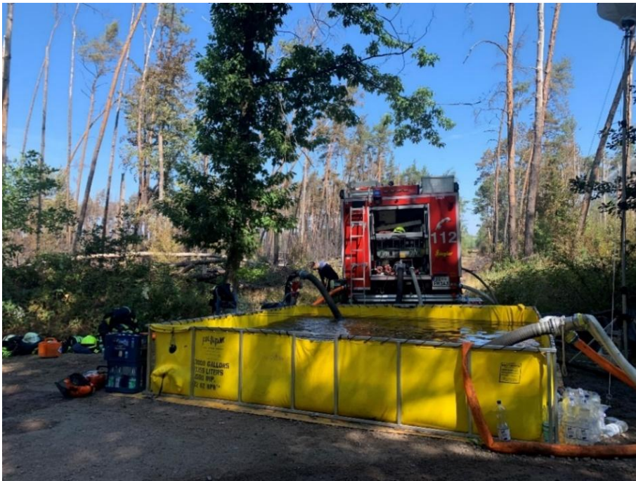
Abb. 6.8: Wasserübergabepunkt mit mobilem Faltbehälter [HMdI]
