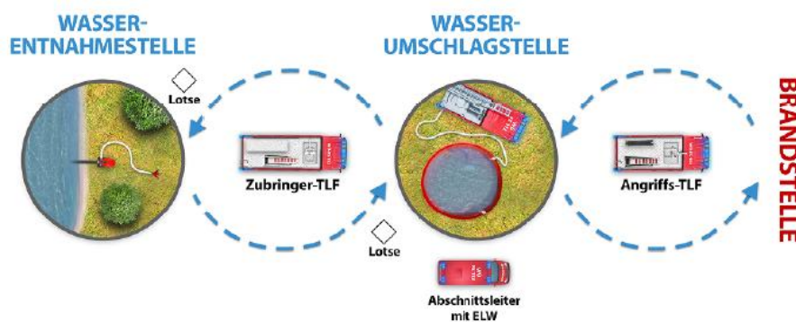
Abb. 6.7: Doppelter Pendelverkehr mit Tanklöschfahrzeugen [2]
