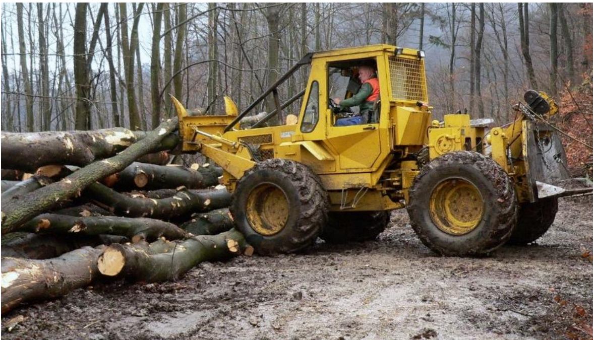
Abb. 8.3: Seilschlepper bei Polterarbeiten [Hessen Forst, K. Eidam]
